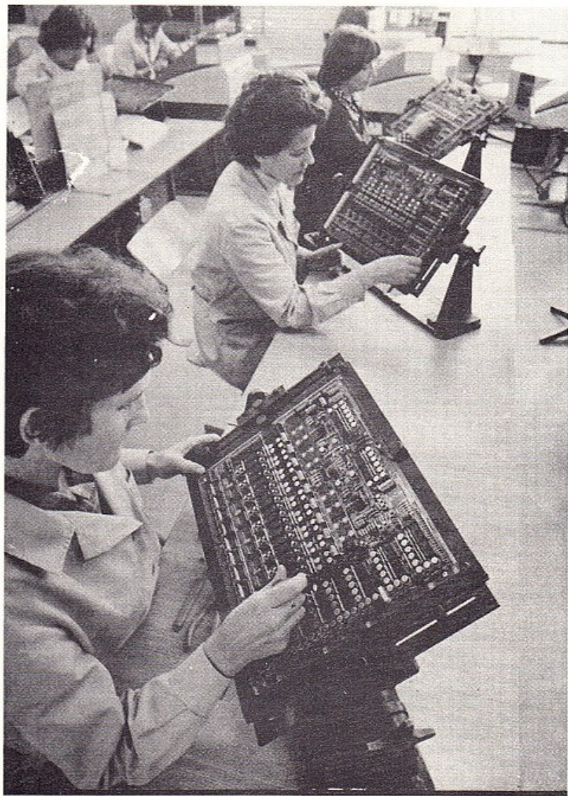
2. Montaż płyt elektroniki pamięci operacyjnej stanowiącej zbiór różnych elementów elektronicznych jak: oporniki, kondensatory, tranzystory, układy scalone itp.
